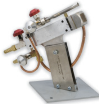
2086.015.003 Major benkebrenner for propan og oksygen Dette er egentlig to brennere: - en for detaljer og en for generell oppvarming
