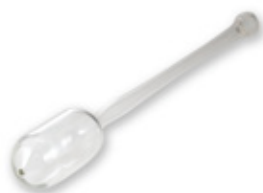
3693.051.002 Glaskolben blåsepipe, sylinder Ø40 mm, 1,5 mm vegg
